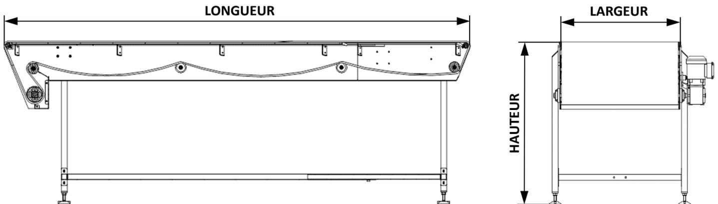
**Hauteur (du sol jusqu'au niveau du tapis) :** de 500 à 1 500 mm.
